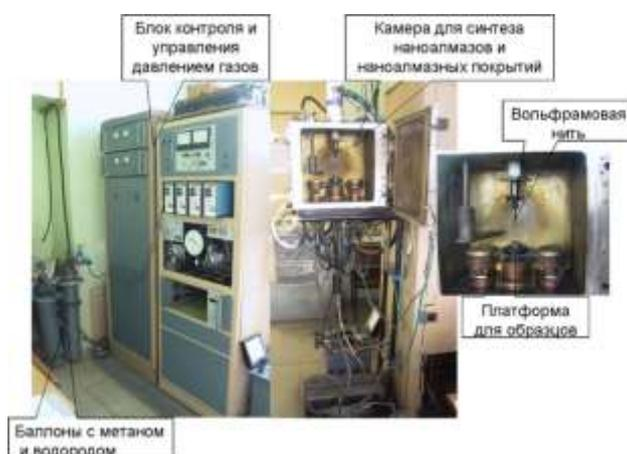
Рис. 5. Лабораторная установка для получения детонационного наноалмаза
